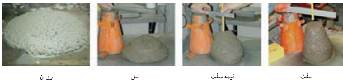
شکل ۱۲- طبقه‌بندی روانی بتن براساس آزمایش اسلامپ
