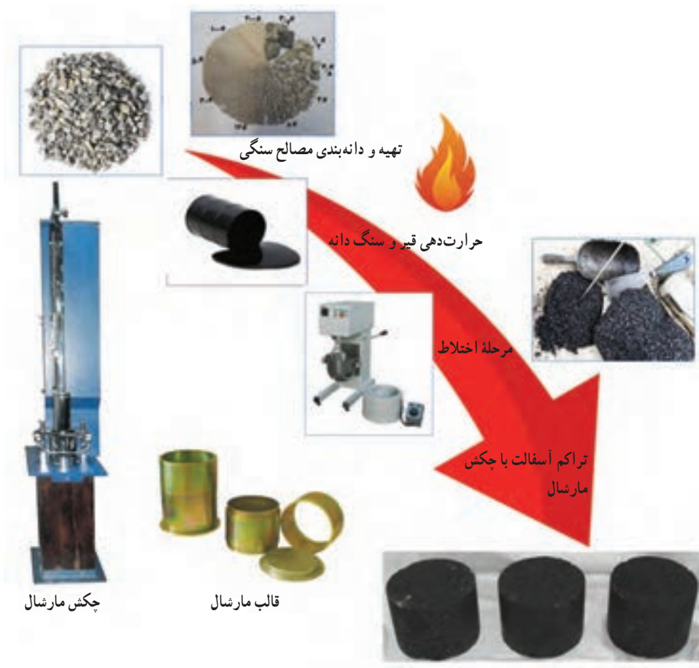
شکل ۲۷- فرایند تولید آسفالت در آزمایشگاه
