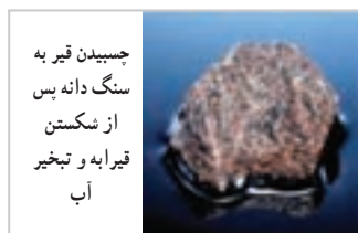
شکل ۲۳- فرایند شکستن قیرآبه در زمان اختلاط با سنگ دانه ها
