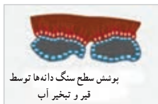
شکل ۲۳- فرایند شکستن قیرآبه در زمان اختلاط با سنگ دانه ها
