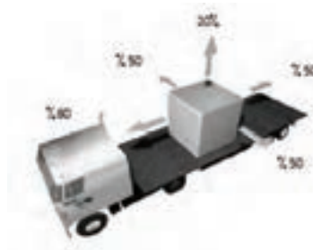
شکل ۲۷- میزان نیروهای وارده به بار در پشت کامیون
