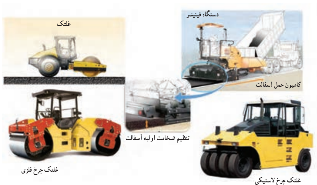
شکل ۳۰- تجهیزات پخش و تراکم آسفالت
