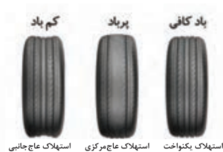
شکل ۱۲- نمایش تایر (باد کافی، پر باد، کم باد)
