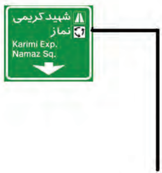
شکل ۲۶ - نمونه‌ای از تابلوهای هدایت مسیر / خروجی بالاسری (کنسولی)
