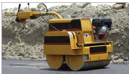
شکل ۴۱- غلتک دستی برای تراکم آسفالت
