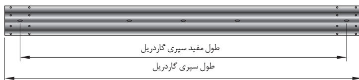
شکل ۶- طول سپری گاردریل و طول مفید آن
