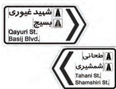
شکل ۲۵ - نمونه‌هایی از تابلوهای هدایت مسیر / خروجی (پرچمی)
