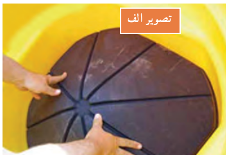
شکل ۲۲- چیدمان بشکه‌ها و قرار دهی مخروط درونی
