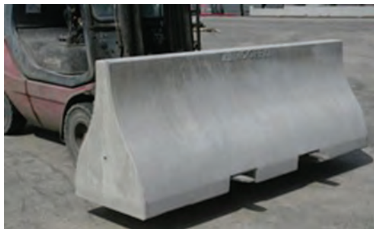
شکل ۵۶- بارگیری نیوجرسی با لیفتراک در محل کارخانه
