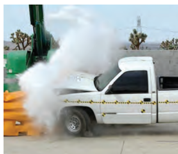
شکل ۱۲- تخریب ضربه‌گیرهای وزنی بشکه‌ای بعد از برخورد
