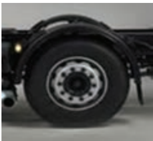
شکل ۳- موقعیت نصب گلگیر و باران گیر
