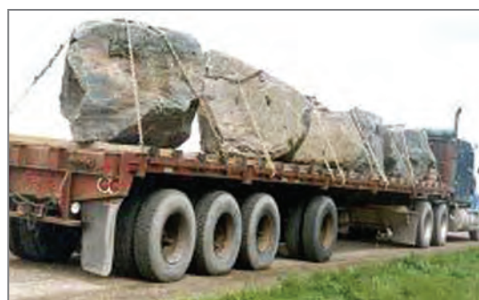
شکل ۱۶- نمونه‌ای از مهار صحیح سنگ‌ها
