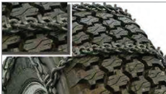
شکل ۱۳- بستن زنجیر چرخ
