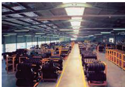
شکل ۱۱- انبار کردن صحیح تایر
