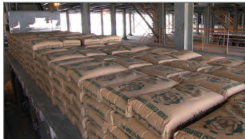
شکل ۱۲- نحوه چیدن کیسه‌ها روی یکدیگر
