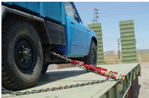
شکل ۲۲- نمونه‌ای از مهار نادرست یک اتومبیل
