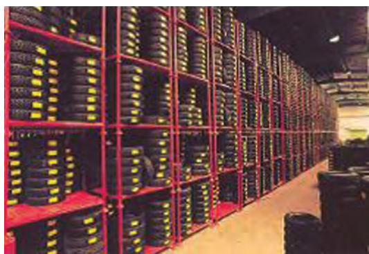
شکل ۱۱- انبار کردن صحیح تایر
