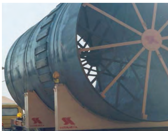
شکل ۵۸- روش مهار بار خاص توسط زین
