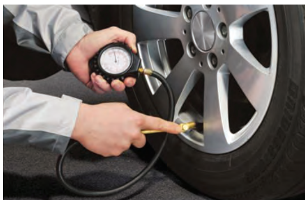
شکل ۱۰- اندازه‌گیری و تنظیم فشار باد تایر
