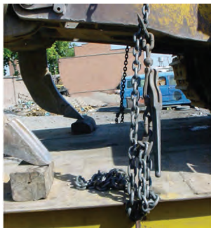
شکل ۲۷- بستن قسمت‌های مفصلی ماشین آلات راه‌سازی
