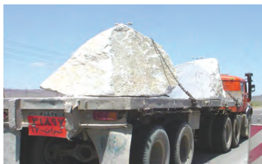
شکل ۱۷- نمونه‌ای از مهار نادرست سنگ‌ها
