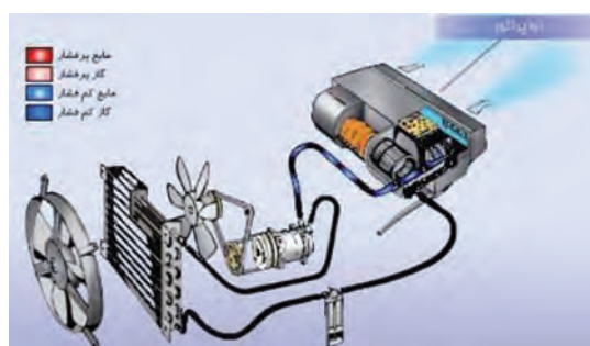
شکل ۲۵ - مدار و اجزای کولر وسیله نقلیه
