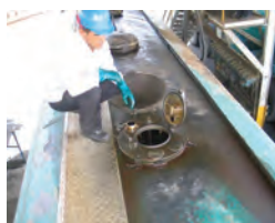
شکل ۴۱- شکل مراحل بارگیری یک فراورده نفتی از طریق دریچه آدم رو
