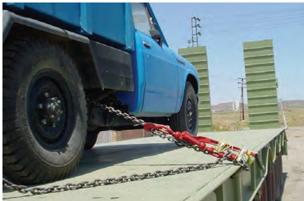
شکل ۲۲- نمونه‌ای از مهار نادرست یک اتومبیل
