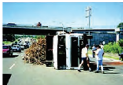
شکل ۱- نمونه‌هایی از عدم مهار مناسب بار
