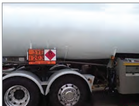
شکل ۳۶- نحوه نمایش تابلوی نارنجی رنگ بر روی وسایل نقلیه حمل مواد خطرناک
