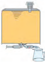
شکل ۲۳- تخلیه آب و رسوبات ته‌نشین شده در مخزن سوخت
