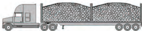
شکل ۴۷- نحوهٔ صحیح مهار عرضی چوب‌ها
