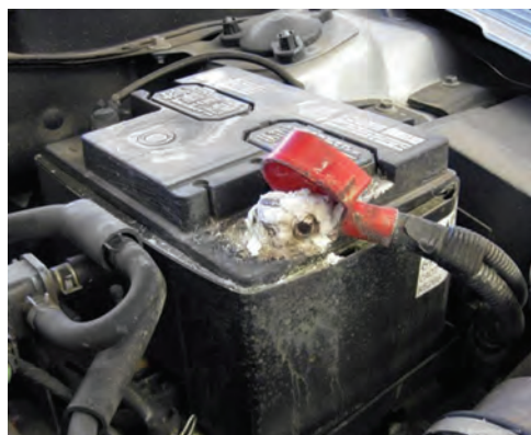
شکل ۴۱- سولفاته کردن قطب باتری
