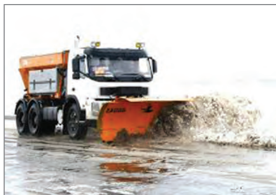
شکل ۱۴- کامیون مجهز شده به تجهیزات برف‌روبی
