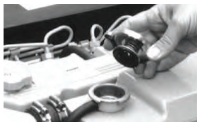
سطح آب حدود ۱ سانتی‌متر پایین‌تر از دهانه رادیاتور باشد.
