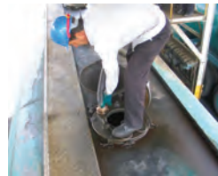
شکل ۴۱- شکل مراحل بارگیری یک فرآورده نفتی از طریق دریچه آدم رو
