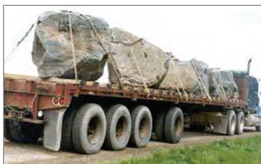
شکل ۱۶- نمونه‌ای از مهار صحیح سنگ‌ها
