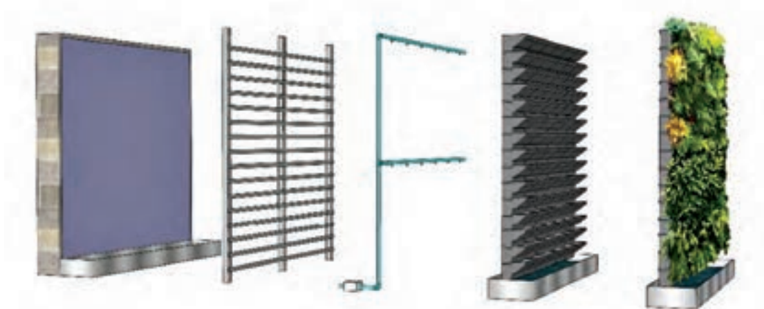
نحوه اتصال گلدان‌های کاشت روی شبکه‌های فلزی
