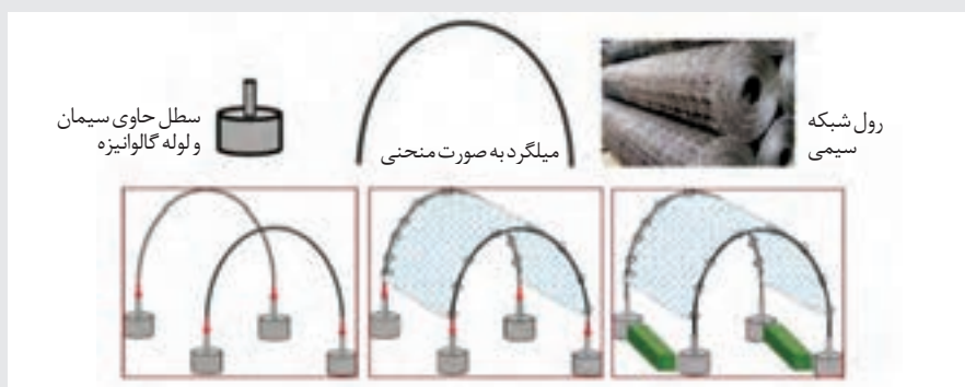
مراحل ساخت تونل سبز توسط شبکه‌های سیمی
