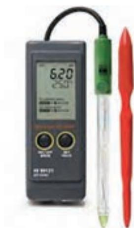
در شکل مقابل یک دستگاه اندازه‌گیری اسیدیته خاک یا pH meter را مشاهده می‌کنید. مشخص کنید دستگاه کدام حالت از محلول را نشان می‌دهد:
