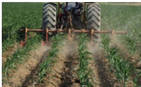
شکل ۳۵- استفاده از کولتیواتور برای کنترل علف هرز در مزرعه ذرت
