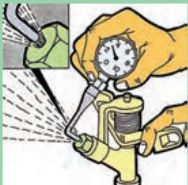
شکل ۲۱- اندازه گیری با فشارسنج بوردون
