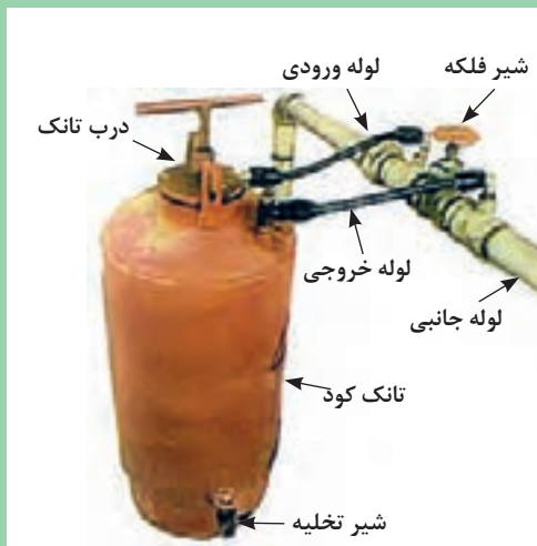
شکل ۳۳- اجزای سیستم توزیع کود
