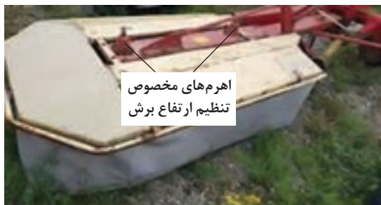
شکل ۲۸- اهرم‌های مخصوص تنظیم ارتفاع برش
