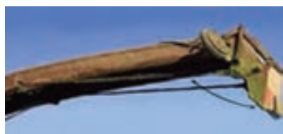
شکل ۵۸- حرکت عمودی کلاهک لوله تخلیه
