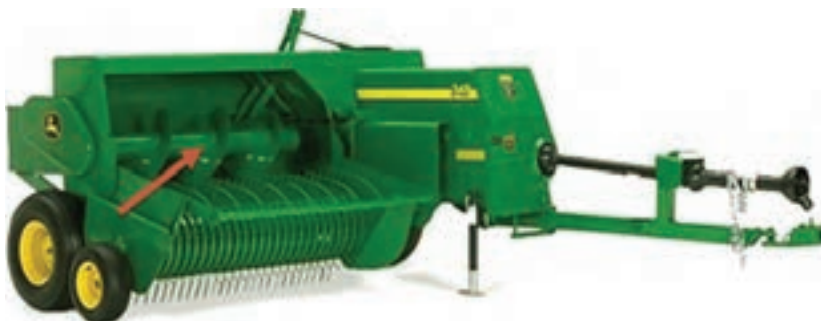
شکل ۵- استوانه مارپیچی برای هدایت علوفه به محفظه تراکم
