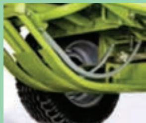
شکل ۱۴- محل قرارگیری نخ‌گیر، راهنمای نخ و سوزن‌ها
