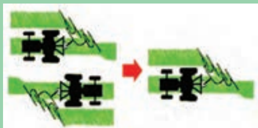
شکل ۱۶- تبدیل کردن چهار ردیف علوفه به یک ردیف
