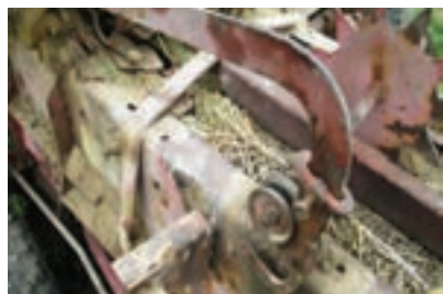
شکل ۲۵- تنظیم طول بسته با استفاده از جابه‌جا کردن مانع بر روی بازوی آزادکن
