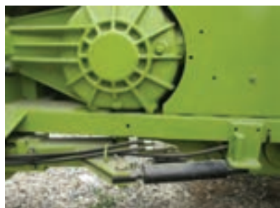
شکل ۲۸- محل بازدید و خروج روغن از جعبه دنده دستگاه بسته‌بند
