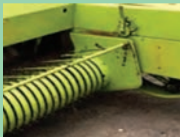
شکل ۲۰- تنظیم ارتفاع بردارنده
