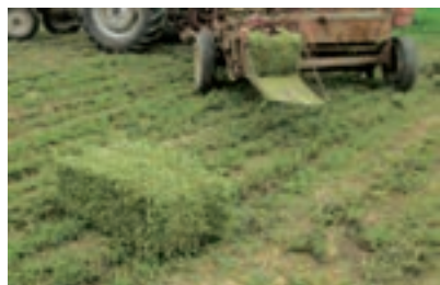
شکل ۲۷- درب انتهایی کانال خروج بسته
