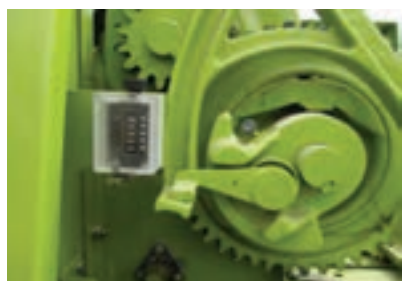
شکل ۲۶- شماره‌انداز بر روی دستگاه بسته‌بند
