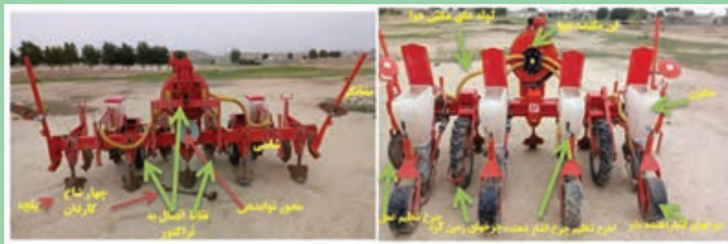
شکل ۱۰- ساختمان ردیف کار پنوماتیکی بدون کود کار از عقب (راست) و جلوی دستگاه (چپ)
