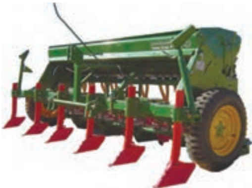
شکل ۷- خطی کار دارای فاروئر
