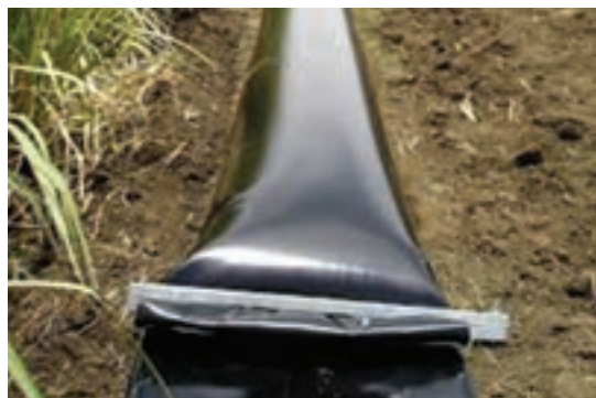
شکل ۱۱- لوله هیدروفلوم با گیره انتهایی
