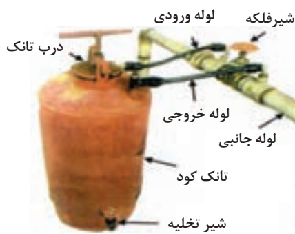
شکل ۲۸- اجزای سیستم توزیع کود
