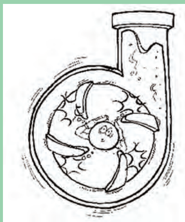
شکل ۱۵- کاویتاسیون در پروانه پمپ
