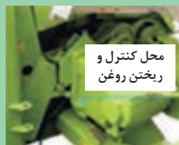
شکل ۶۵- جعبه دنده باردهی غلتک‌های تغذیه
