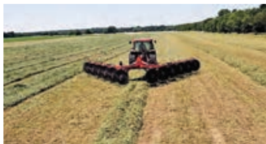
شکل ۸- شانه چرخي دوقلو با چرخ های یکپارچه
