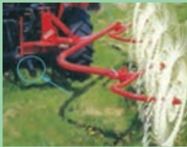
شکل ۹- اتصال شانه خورشیدی به تراکتور
