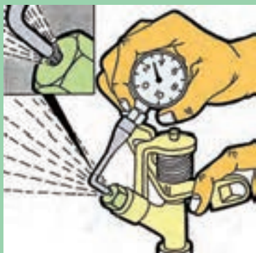
شکل ۲۱- اندازه گیری با فشارسنج بوردون
