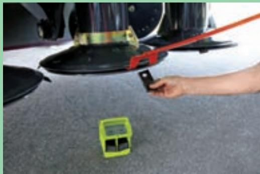
شکل ۲۰- نحوه تعویض تیغه در دروگر استوانه‌ای
