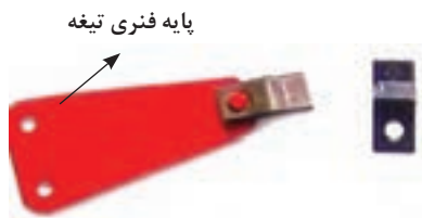
شکل ۶- تیغه‌های یک نوع دروگر استوانه‌ای به همراه پایه فنری
