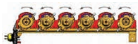
شکل ۸- جهت چرخش بشقاب‌ها در دروگر بشقابی
