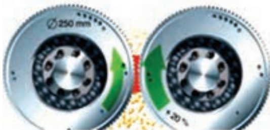
شکل ۵۵- استوانه‌های واحد دوباره خردکن
