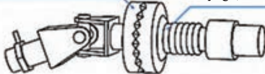
الف) کلاچ در حالت قطع نیرو
