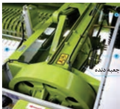
شکل ۱۲- مسیر انتقال توان در دستگاه بسته‌بند
