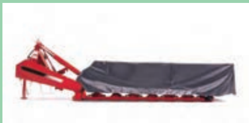
شکل ۱۰- حفاظ دستگاه دروگر استوانه‌ای و بشقابی
