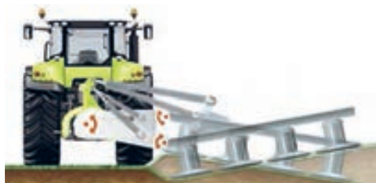
شکل ۱۲- حالت‌های کاری دروگر استوانه‌ای در شیب
