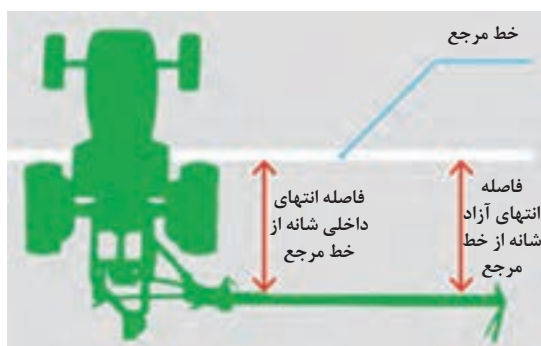
شکل ۳۳- تنظیم تقدم شانه برش
