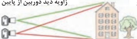
نمایش نحوه تغییر در پرسپکتیو تصویر در اثر تغییر زاویه دید دوربین
