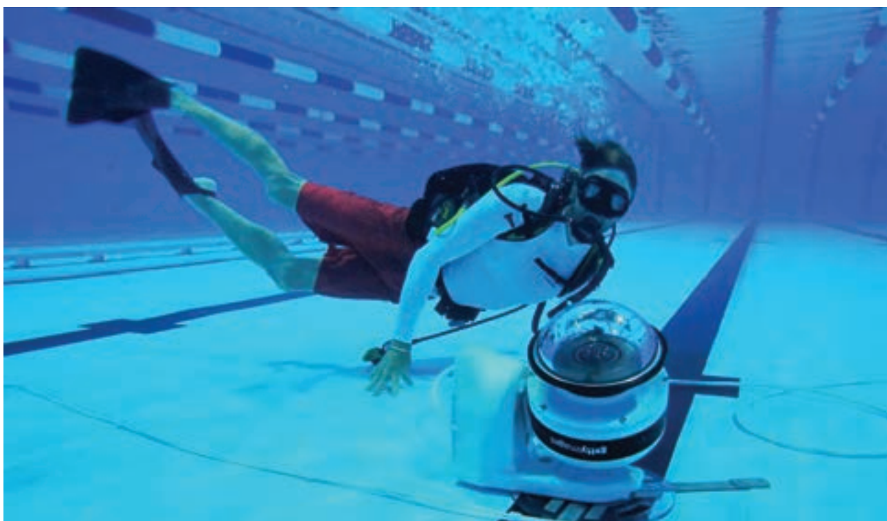
▲ تصویر ۱۰ | دوربین های رباتیک نصب شده در زیر استخر شنا
