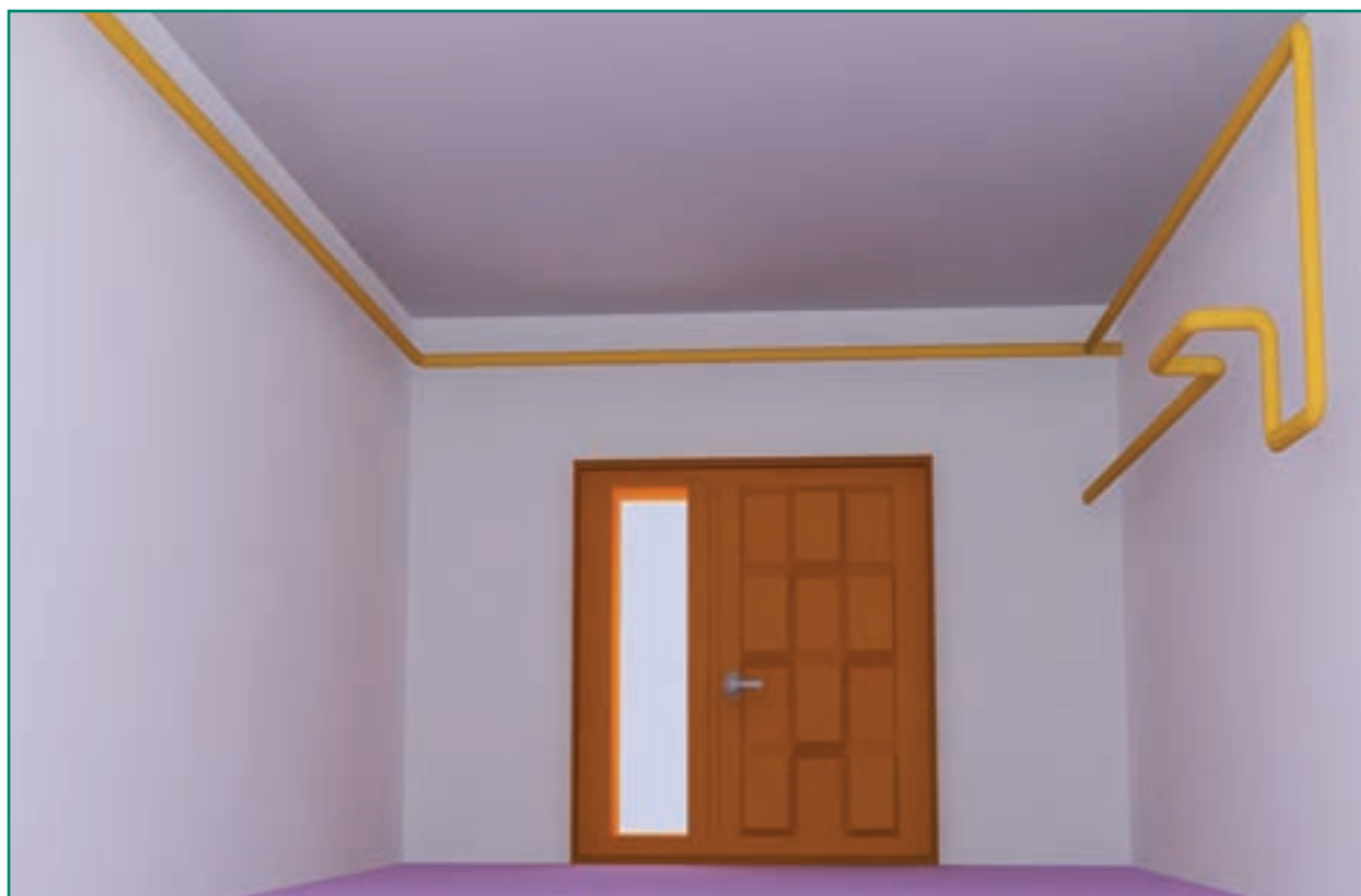
شکل ۴-۲۳ الف نمایش مسیر لوله‌ها در داخل راهرو
