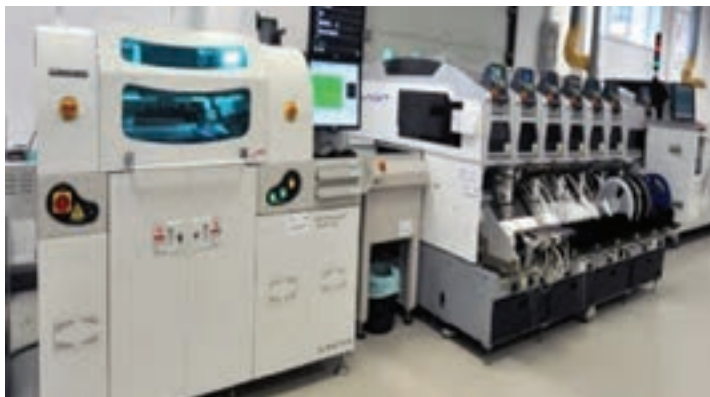
شکل ۳-۱۱ دستگاه تمام خودکار مونتاژ قطعات SMD
