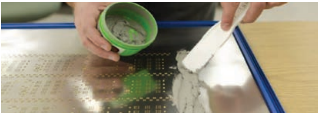
شکل ۱۲-۳ خمیر اندود کردن لحیم به کمک شابلون
