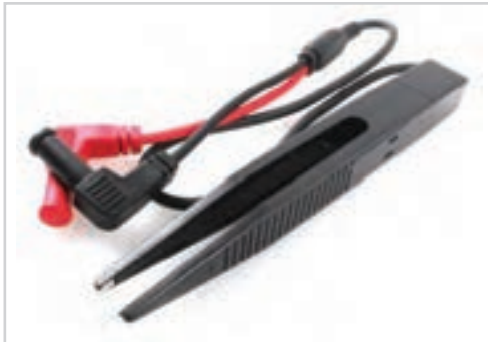
شکل ۳-۱۵ پنس قابل اتصال به مولتی متر
