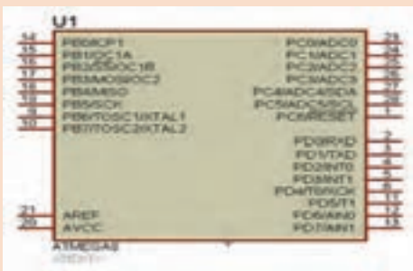
شکل ۶-۲۲ ترسیم نقشه شکل ۶-۲۰ با ATmega ۸
