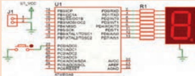
شکل ۷-۳۸ مدار شمارنده یک رقمی
