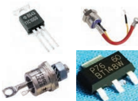
شکل ۸-۷ بسته‌بندی چند نمونه SCR
