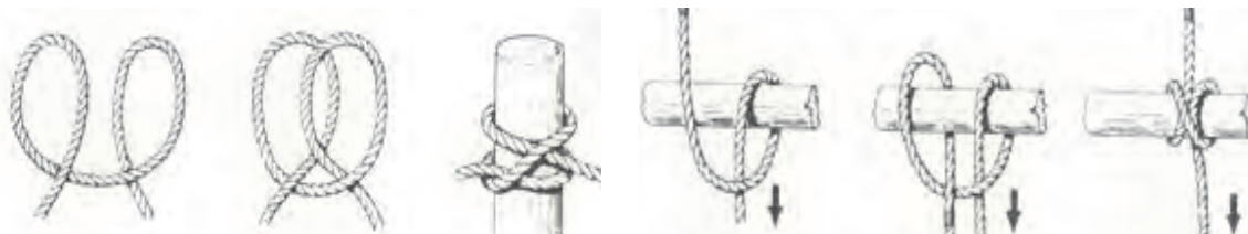
نحوه زدن گره ۲ خفت روی حلقه طناب خفت کنده
