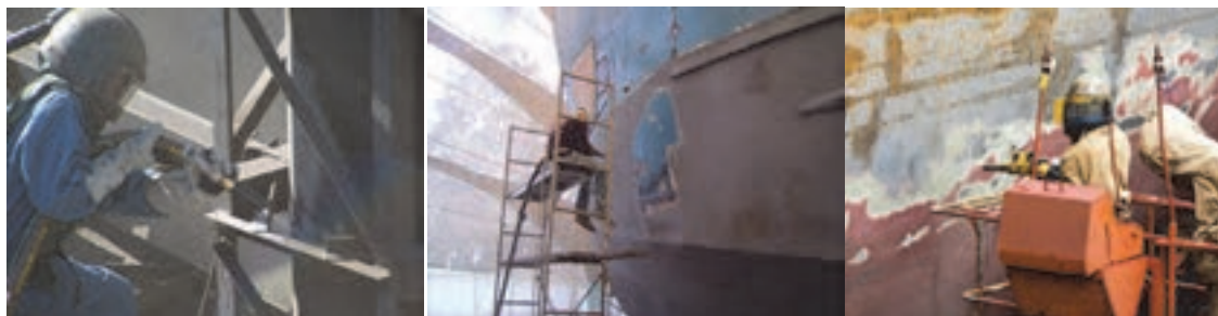
شکل ۱-۷ زنگ‌زدایی در اسکله خشک
