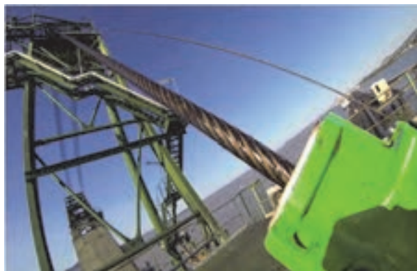
شکل ۲۲-۱ روان کاری طناب سیمی با گریس
