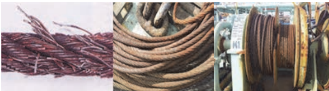
شکل ۱۶-۱ نمونه‌هایی از عدم نگهداری صحیح ماشین‌آلات
