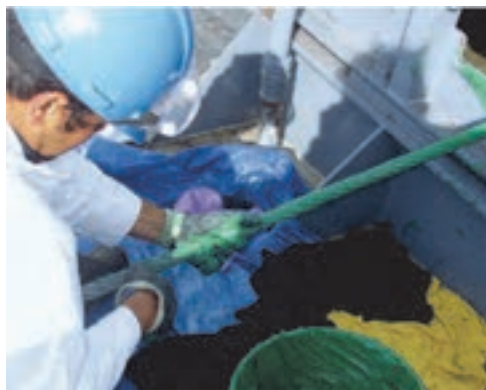
شکل ۲۲-۱ روان کاری طناب سیمی با گریس
