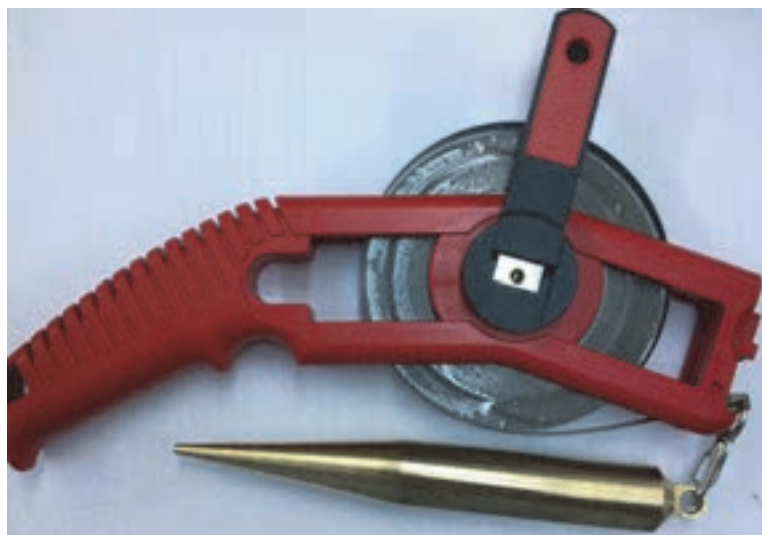
شکل ۳-۶ Sounding tape برای اندازه‌گیری سطح مخزن
