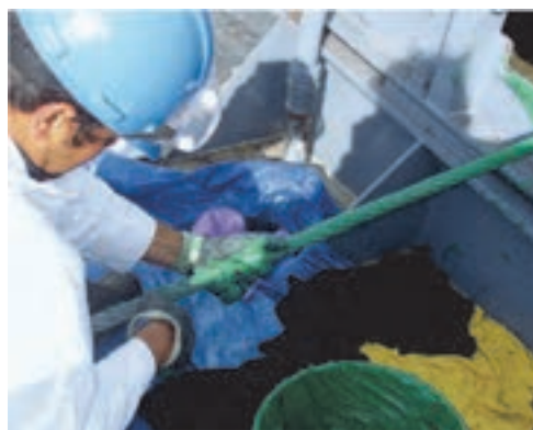
شکل ۲۲-۱ روان کاری طناب سیمی با گریس
