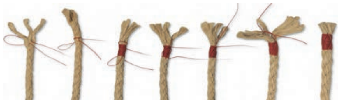
شکل ۲-۲۱- نخ‌پیچی کردن انتهای طناب
