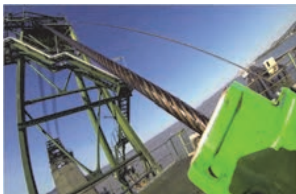
شکل ۲۲-۱ روان کاری طناب سیمی با گریس
