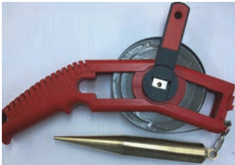
شکل ۳-۶ Sounding tape برای اندازه‌گیری سطح مخزن
