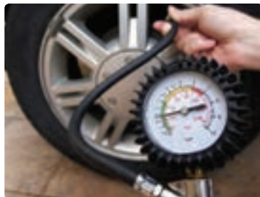
ب) اندازه‌گیری فشار هوای درون لاستیک خودرو
