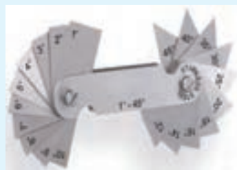
شابلون زاویه (اندازه گیری زاویه قطعات)
