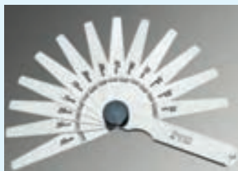
شابلون فیلر (اندازه گیری شکاف‌ها و شیارها)
