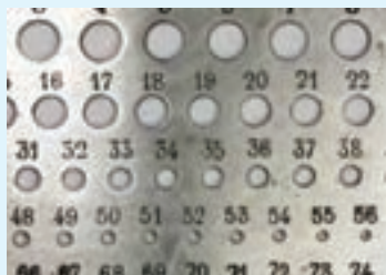
شابلون میله (اندازه گیری قطر میله‌ها)
