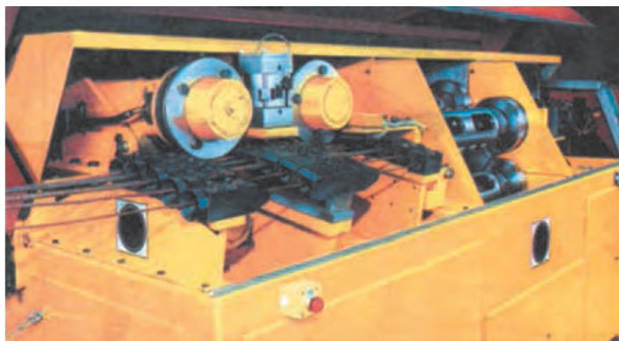
شکل ۲۹ - دستگاه کشش برقی برای صاف کردن میلگرد ▲
