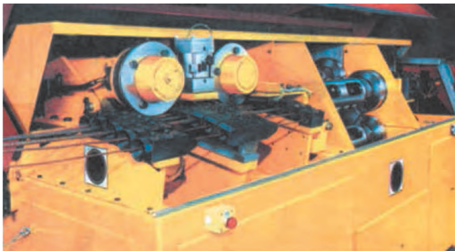
شکل ۲۹ - دستگاه کشش برقی برای صاف کردن میلگرد ▲
