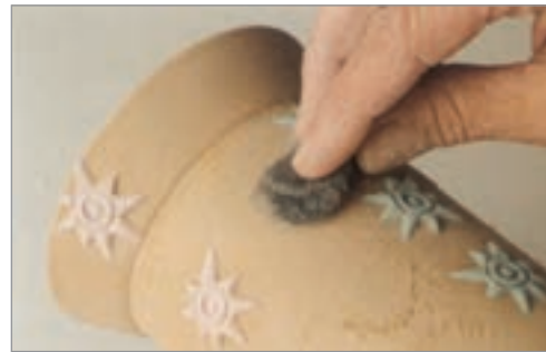
شکل ۱۴- پرداخت بدنه پس از قرار دادن طرح
