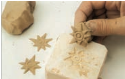
شکل ۱۳- فشار دادن مقداری گل درون قالب
