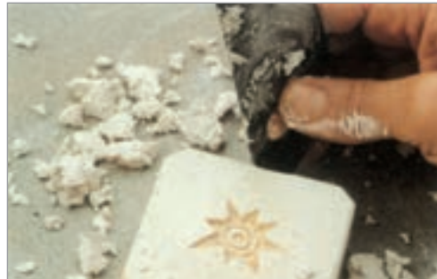
شکل ۱۲- تراشیدن طرح بر روی قالب گچی
