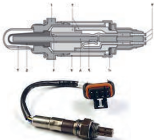
شکل ۵- اجزای حسگر اکسیژن
