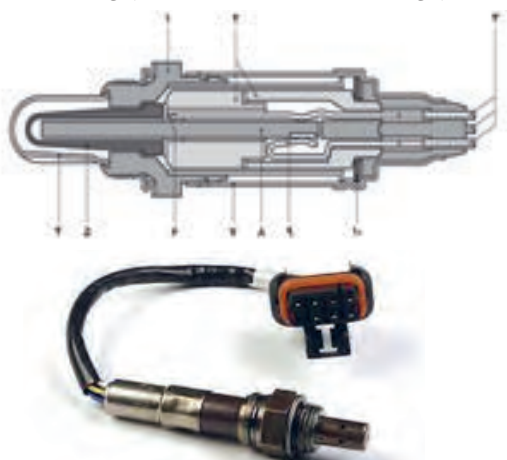
شکل ۵- اجزای حسگر اکسیژن
