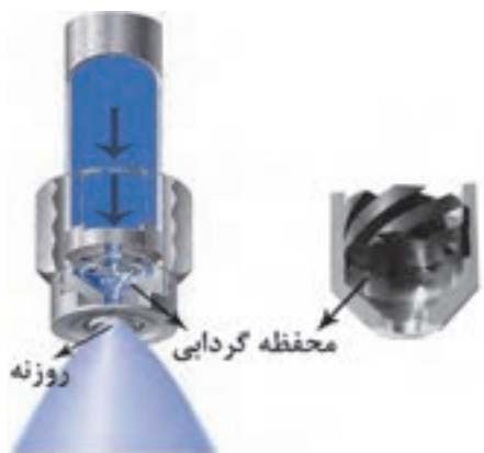
شکل ۲۵- افشانک نازلی نوع گردابی
