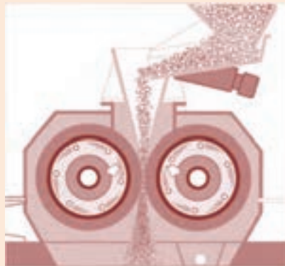
شکل ۳۰- جهت چرخش استوانه ها در سنگ شکن غلتکی
