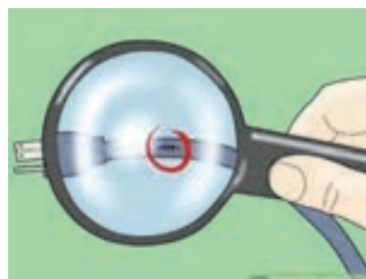
الف) پارگی پوشش سیم تغذیه
