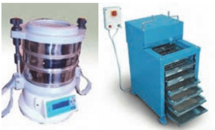
شکل ۱۰- دستگاه لرزاننده در اشکال و ابعاد مختلف
