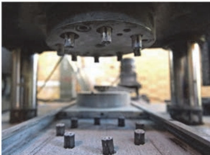
شکل ۱۱- پرس با قالب حاوی ۸ حفره
