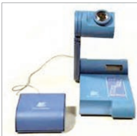
شکل ۳-۷- دو نمونه دستگاه الکتریکی برای اندازه‌گیری نقطه ذوب
