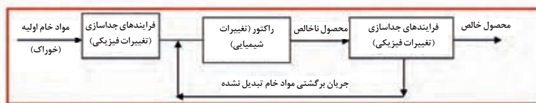
شکل ۳-۴- طرح ساده‌ای از یک فرایند شیمیایی
