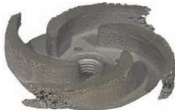
شکل ۳-۱۹- آسیب‌دیدگی پروانه پمپ در اثر پدیده کاویتاسیون
