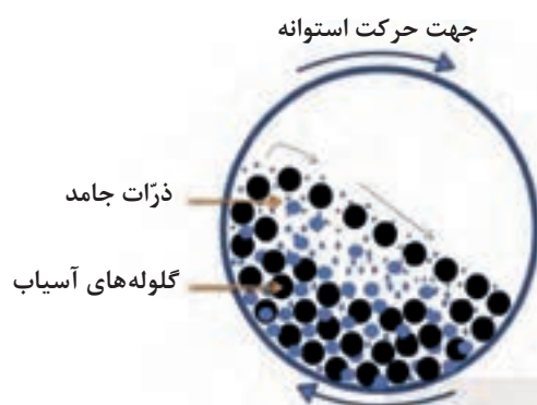
شکل ۴۳-۳. نمایی از سطح مقطع آسیاب دوار (گلوله‌ای)
