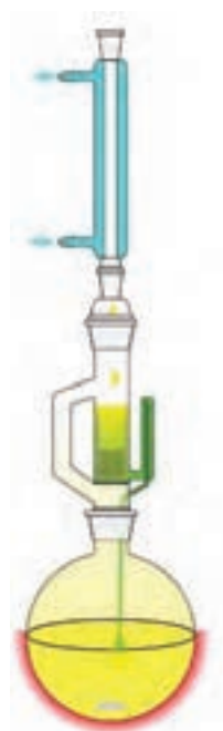
شکل ۱۷-۵- شمای ساده‌ای از سوکسله
