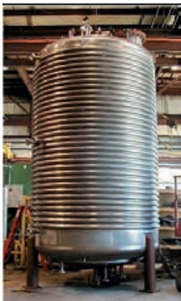
شکل ۵-۴- راکتور ناپیوسته صنعتی با سامانه گرمایی
