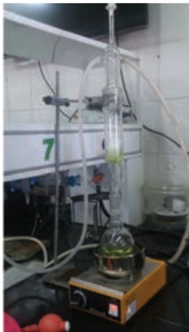
شکل ۱۷-۵- شمای ساده‌ای از سوکسله
