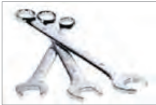
شکل ۱۷- آچار یک سر تخت و یک سر رینگی
