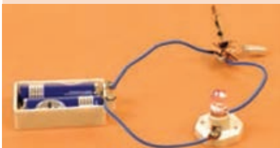
شکل ۳۴- مدار ساخته شده با راه انداز (استارت) لامپ مهتابی به عنوان ترموستات
