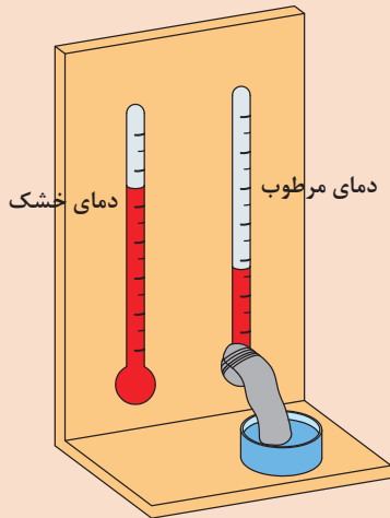
شکل ۱۱- آزمایش تعیین رطوبت نسبی هوا
