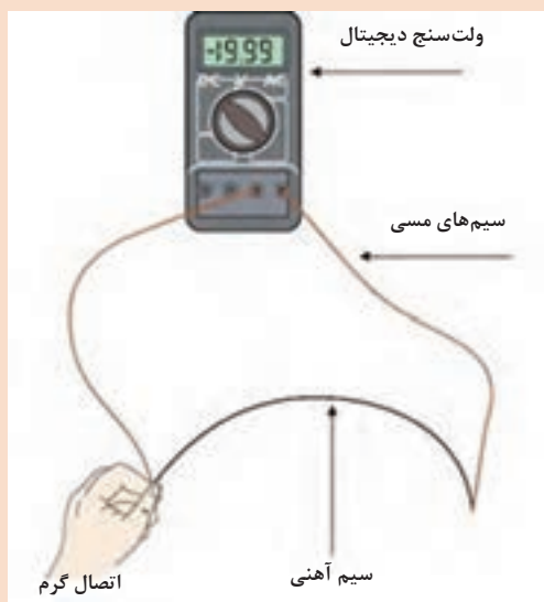
شکل ۲۲- ساخت یک ترموکوپل ساده
