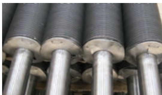
شکل ۲۶- لوله‌های پره‌دار در خنک‌کننده‌های هوایی
