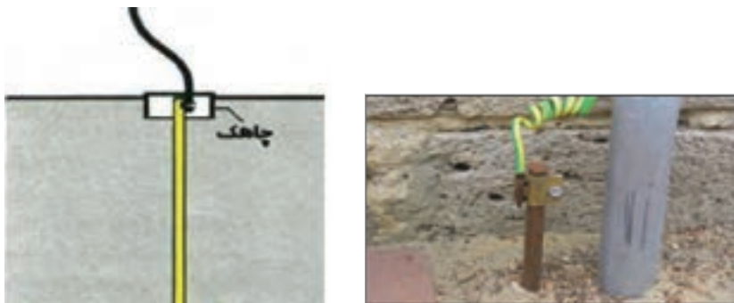
شکل ۴ - شیوه اتصال به چاه ارت
