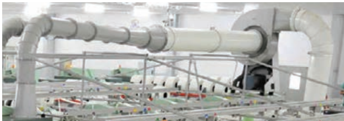
شکل ۲۴- تقویت فشار انتقال الیاف
