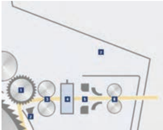
شکل ۴۲- سیستم جمع‌آوری تار عنکبوتی با کنترل کیفیت فتیله
