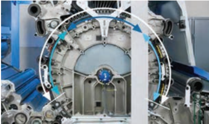
شکل ۱۴- محل‌هایی که روی سیلندر اصلی عمل کاردینگ صورت می‌گیرد.
