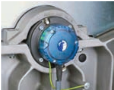
شکل ۱۷- سنسور تشخیص ناخالصی و تنظیمات
