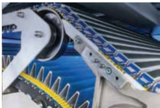
شکل ۲۹- حرکت پروفیل های فلت روی تسمه های کلاهدک
