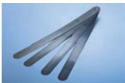
شکل ۱۸- دسته فیلر برای گیج‌گذاری ماشین کارد
