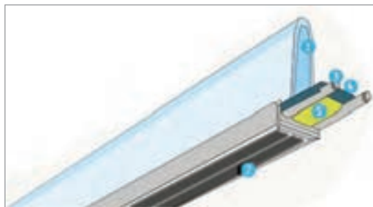
شکل ۲۷- تصویری از ساختمان یک پروفیل فلت کلاهدک و سوزن های روی آن
