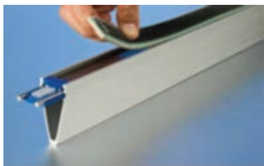
شکل ۳۱- تعویض آسان فلت که آهنربا دارد
