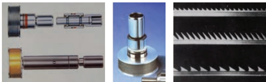
شکل ۱۰- نمایی از زنده و انواع خارهای آن
