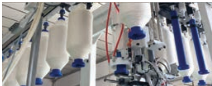
شکل ۳۳- انتقال اتوماتیک بوبین‌های نیمچه نخ از فلایر به رینگ و جمع‌آوری ماسوره‌ها
