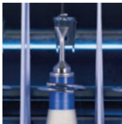
شکل ۲۲- راهنما و حلقه کنترل بالون و صفحه جداکننده و ماسوره نخ
