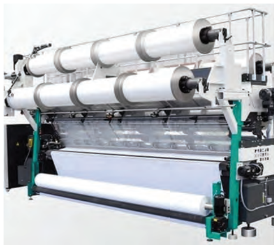
شکل ۲۵- ماشین بافندگی حلقوی تاری
