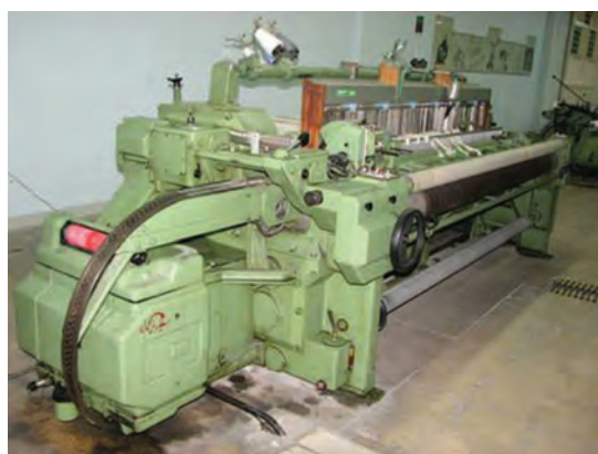
شکل ۱۷- ماشین بافندگی با پودگذاری راپیر
