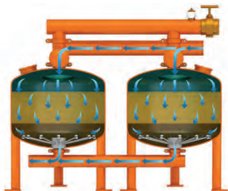
شکل ۶۰- روش تصفیه شنی و تمیز کردن شن‌ها
