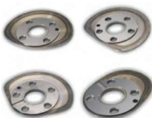
شکل ۵۴- بادامک‌ها در ماشین بافندگی
