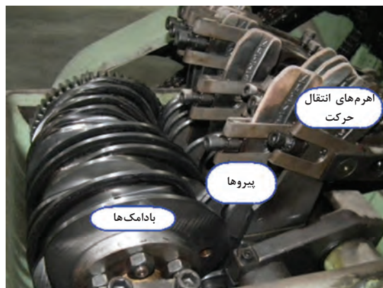
شکل ۵۴- بادامک‌ها در ماشین بافندگی
