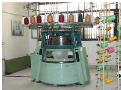
شکل ۲۴- ماشین بافندگی پودی (گرد باف)
