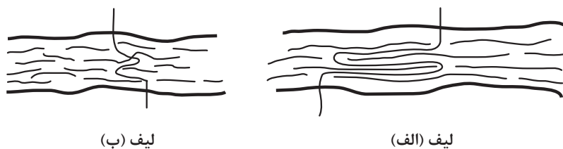
شکل ۵- نمایش قرار گرفتن مولکول‌های بلند و کوتاه در داخل لیف
