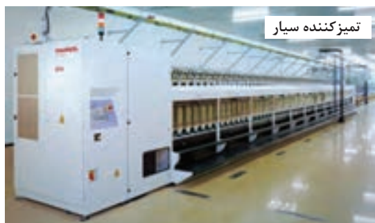
شکل ۵۲- تمیزکننده سیار روی فلایر
