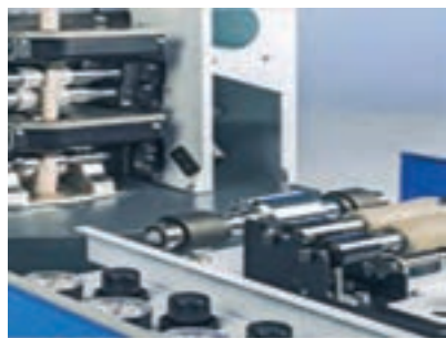
شکل ۱۱- کالندر و اتولولر در چندلاکنی
