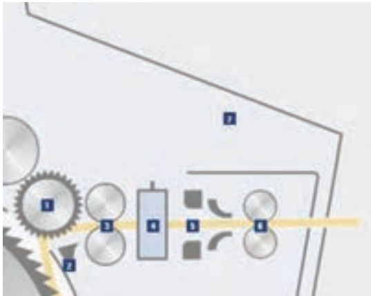
شکل ۴۲- سیستم جمع‌آوری تار عنکبوتی با کنترل کیفیت فتیله
