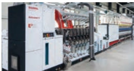
شکل ۳۶- تمیزکننده سیار با دمنده‌ها و مکنده‌های روی آن
