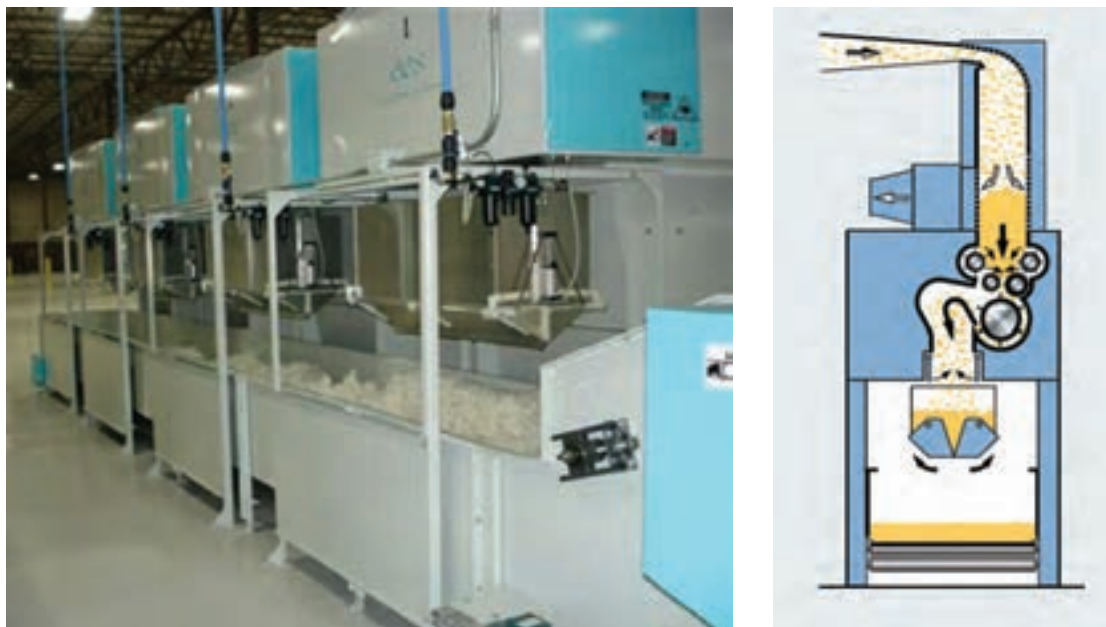
شکل ۶- دستگاه تغذیه وزنی چند ترازویی و عملکرد درون آن
