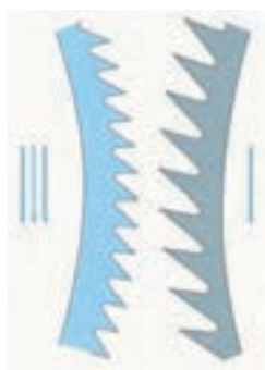
شکل ۳۸- جهت متقابل نوک سوزن‌های سیلندر اصلی و سوزن‌های دافر (point to point)
