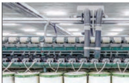
شکل ۱۶- تمیزکننده سیار روی ماشین چرخانه
