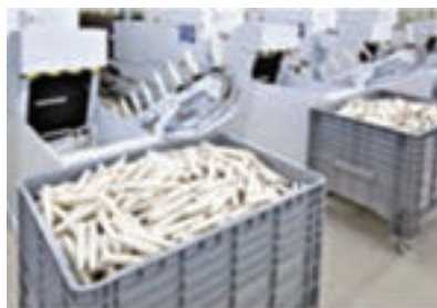
شکل ۳۳- انتقال اتوماتیک بوبین‌های نیمچه نخ از فلایر به رینگ و جمع‌آوری ماسوره‌ها
