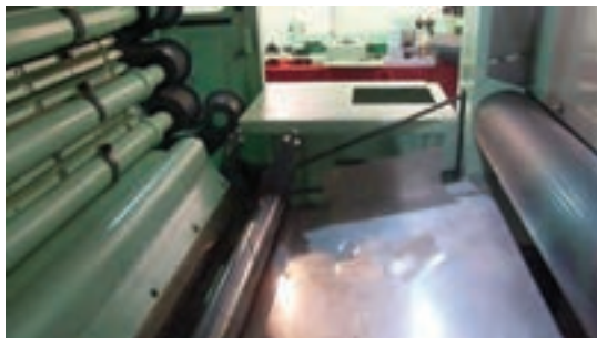
شکل ۱۰- سینی و غلتک تغذیه در سیستم قدیمی
