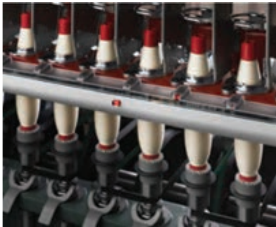
شکل ۳- فاصله دو دوک متوالی در دستگاه رینگ
