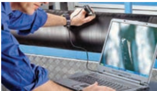
شکل ۲۲- ابزارهای مشاهده عیوب نوار اره‌ای (وایر) کارد
