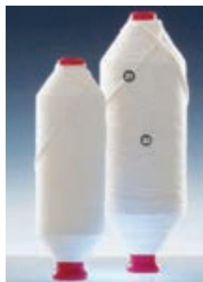
شکل ۴۱- بوبین پر شده نیمچه نخ
