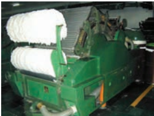
شکل ۴- تغذیه کارد با بالش
