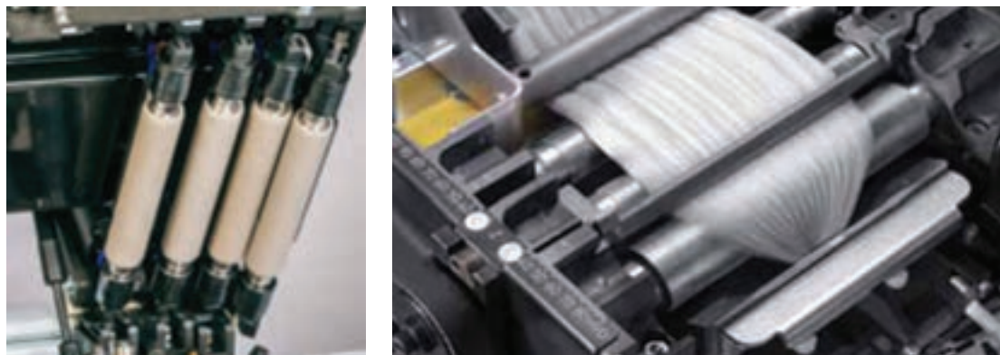
شکل ۷- نمایی از غلتک‌های زیری کشش و غلتک‌های رویی در یک ماشین چندلاکنی
