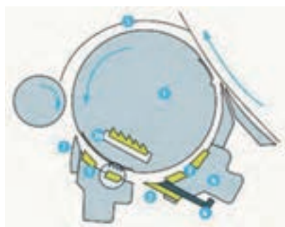
شکل ۱۲- قسمت‌هایی که عمل کارد را در زیر تیگرین انجام می‌دهند.
