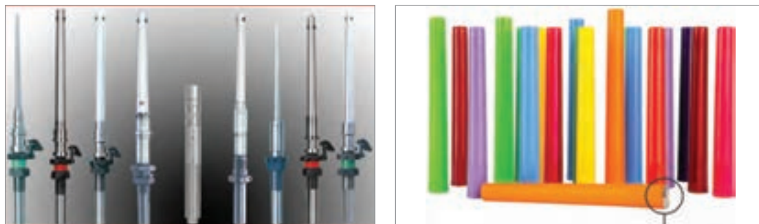
شکل ۲۷- انواع ماسوره پلاستیکی رینگ و انواع اسپیندل رینگ
