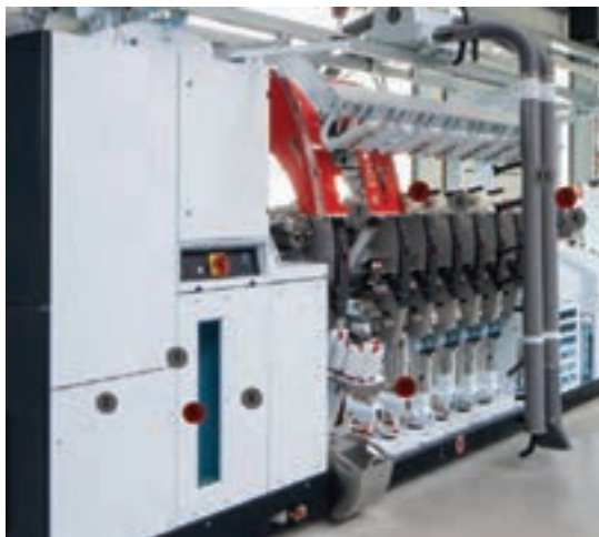
شکل ۵۴- تمیزکننده خودکار اتوکنر
