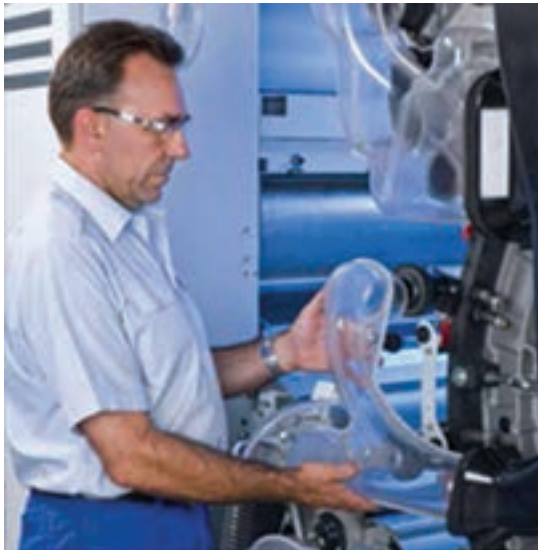
شکل ۵۲- سهولت نصب و خارج کردن کانال‌های هوا و درب‌های آن در کاردهای جدید.
