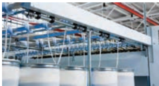
شکل ۲۱- نمای قفسه دستگاه فلایر
