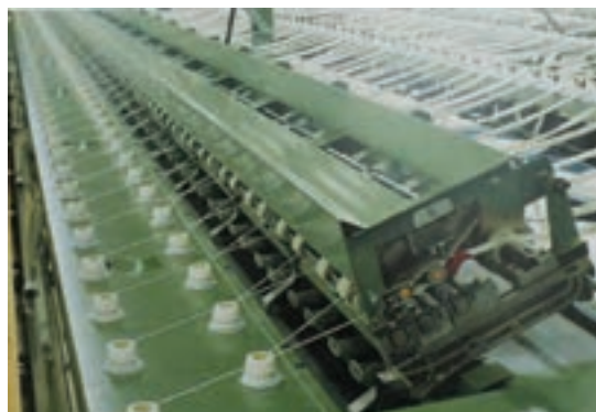
شکل ۳۳- خروج نیمچه نخ از منطقه کشش
