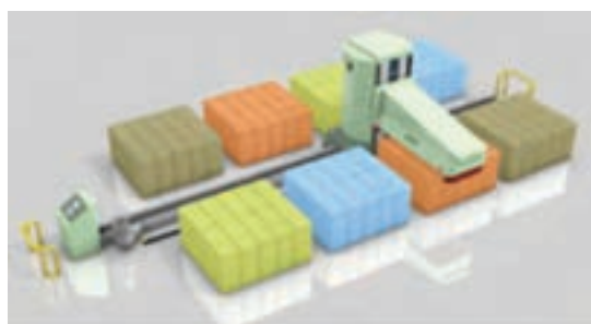
شکل ۳۲- چیدمان ۸ قسمتی عدل‌ها
