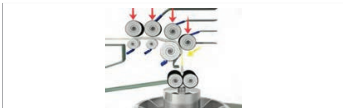
شکل ۸- چگونگی قرار گرفتن غلتک‌های کشش و غلتک کاندرا
