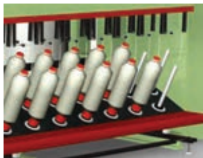
شکل ۴۷- شکل داف کردن بوبین
