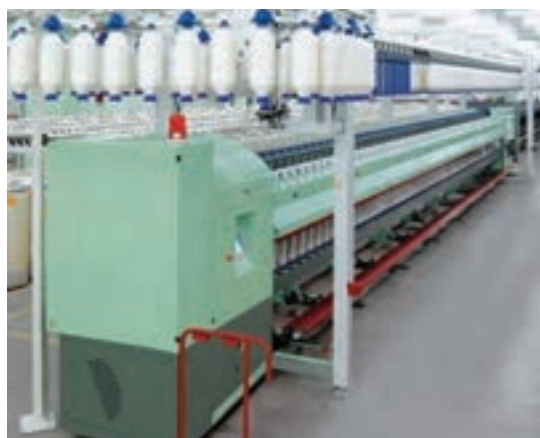
شکل ۱۹- نمایی از ماشین فلایر (نیم تاب)
