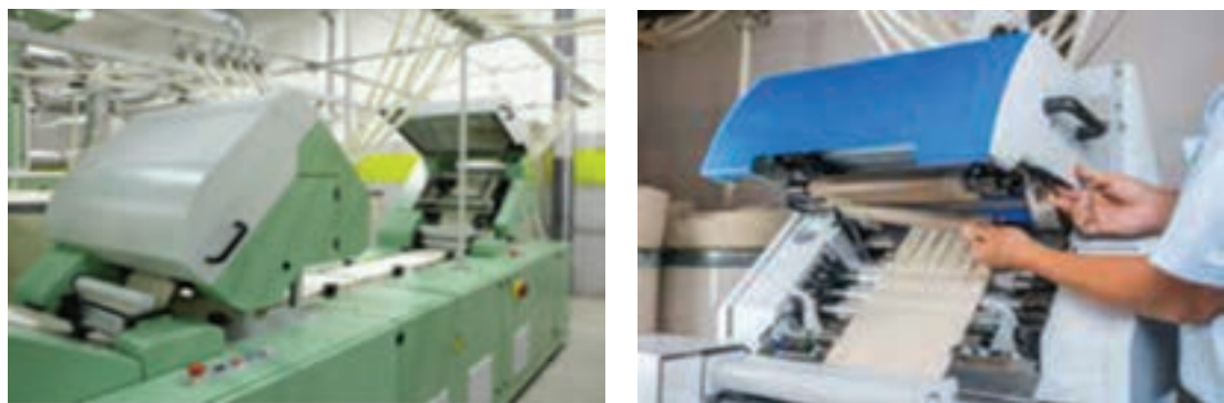
شکل ۲۳- نمای عمل تغذیه و کشش در ماشین بالشچه
