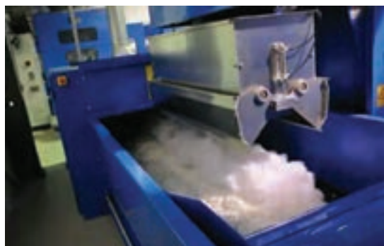
شکل ۵- سیستم تغذیه با یک ترازو (وزنی)
