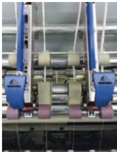
شکل ۹- تصویر واقعی سیستم کششی در رینگ
