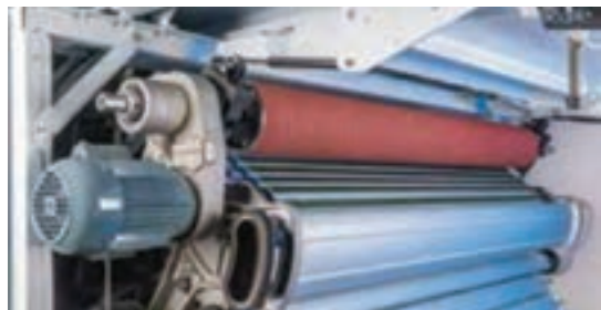
شکل ۳۶- دستگاه سنگ‌زدن فلت‌های کلاhek
