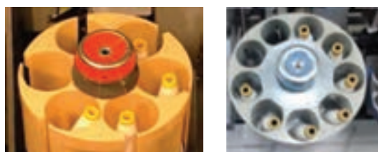
شکل ۴۲- دو نمونه مگازین ۶ و ۱۰ تایی
