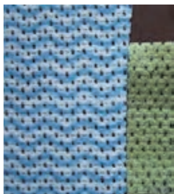
شکل ۸ منسوج بی‌بافت تهیه شده از طریق روش حرارتی منسوج تهیه شده از طریق فشار آب
