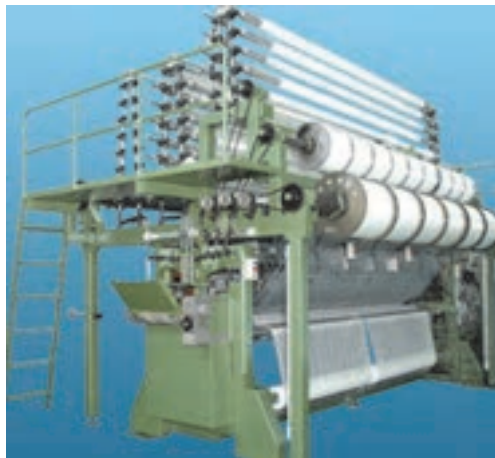
شکل ۴ دستگاه بافندگی حلقوی تاری، نمونه پارچه‌های با ساختار بافت حلقوی تاری
