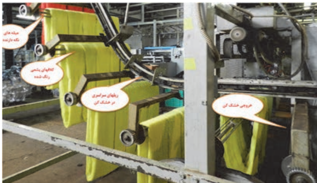
شکل ۲۷ خشک‌کن کلاف مداوم
