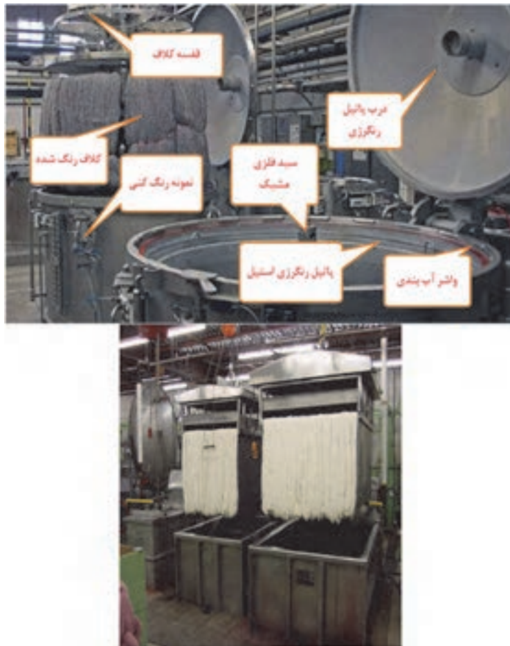
شکل ۲۶ دو ماشین با قابلیت رنگرزی کلاف با ویژگی کالا ثابت و محلول متحرک
