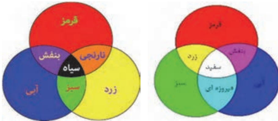
شکل ۱۷ اختلاط ۳ افزایشی رنگ اصلی در منابع نوری و اختلاط کاهشی ۳ رنگ اصلی در مواد رنگی
