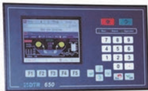
شکل ۹ تصویر یک صفحه‌ی پروگرامر ماشین جت
