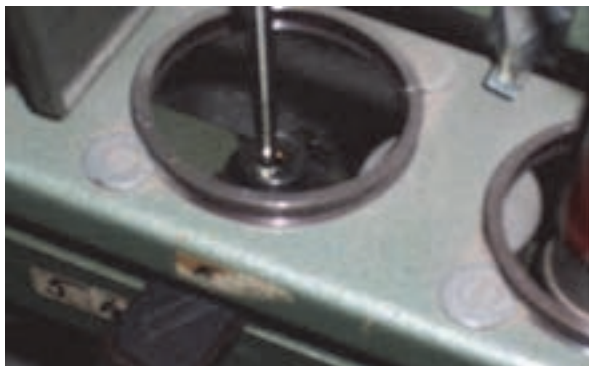
شکل ۱۶ روغن کاری یاتاقان دوک
