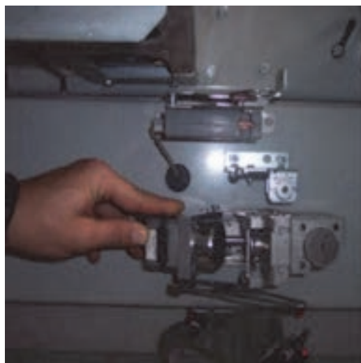
شکل ۷ گره زن نصب شده روی دستگاه
