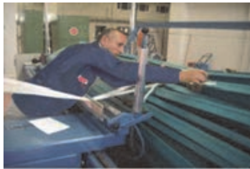
شکل ۲۲ وصل کردن نخ‌ها به میخ روی درام
