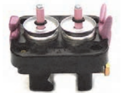
شکل ۳۶ دستگاه کشیدگی نخ با صفحه و فنر
