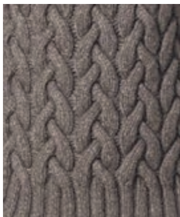
شکل ۲ نحوه تهیه بافت حلقوی پودی و نمونه بافته شده آن با دست
