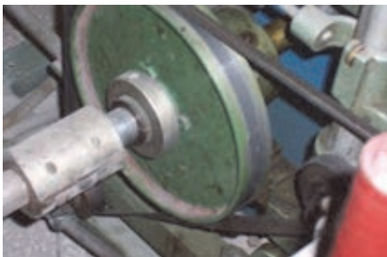
شکل ۱۸ پولی و تسمه انتقال حرکت
