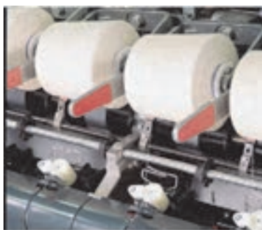
شکل ۲۵ راهنمای متحرک پیچش نخ (تراورس)
