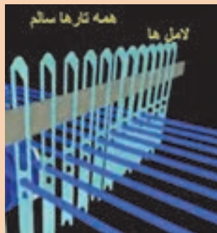
شکل ۳۵ نحوه توقف ماشین در اثر پارگی یک تار
