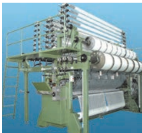
شکل ۴ دستگاه بافندگی حلقوی تاری، نمونه پارچه‌های با ساختار بافت حلقوی تاری
