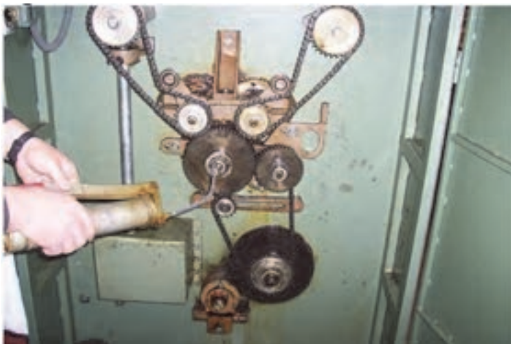
شکل ۱۷ روغن کاری و گریس کاری زنجیرها
