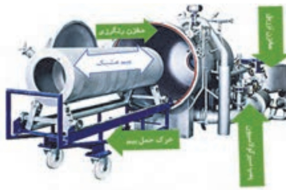
شکل ۱۲ تصویر قسمتهایی از ماشین رنگریزی بیم
