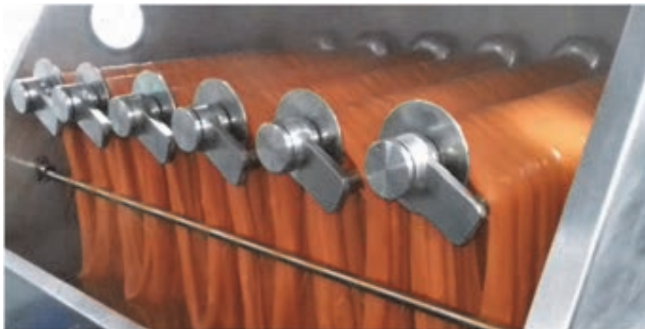
شکل ۲۵ نحوه‌ی قرارگیری کلاف‌ها بر روی بازوهای افقی مشبک چرخان در یک ماشین کلاف رنگ‌کنی
