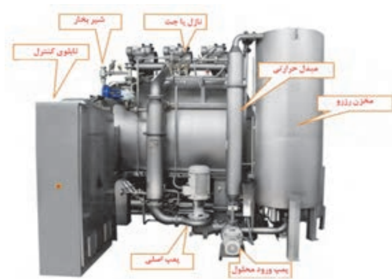
شکل ۷ تصویر قسمت‌های اصلی یک ماشین رنگری جت
